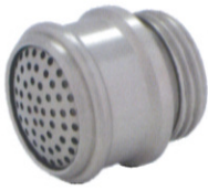
ステンレスノズル HK500 用 0-12204 0 HK150 用 0-12205 7 各¥3,000 (税抜) セラミックノズルに比べて熱効率が高く破損の心配もありません。
